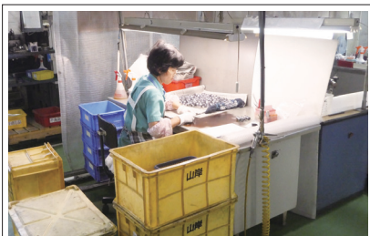
4 局所照明を使い、作業がしやすい視環境を確保しました
