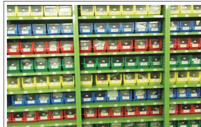
3 色分けやラベルの表示を使った保管方法で資材の取り違いや作業ミスを防ぎました
